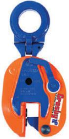
Las garras para astilleros IPBU (U) Z se utilizan para izar, trasladar y colocar secciones de barcos completas. Estas garras tienen un dispositivo de traba en posición abierta y cerrada, lo que asegura una total confiabilidad. Deben utilizarse exclusivamente para perfiles de cuadernas (no para placas).
