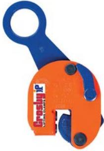
La garra para vigas IPBKZ se utiliza para izar, trasladar y apilar vigas "H". Un ojo de izaje sobre el centro permite que la brida de la viga permanezca en posición vertical. Esta serie de garras puede usarse para mover, trasladar y apilar vertical y horizontalmente distintos tipos de diseños estructurales, tales como vigas en "H", ángulos, etc., dependiendo de la aplicación deseada.
