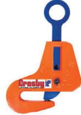
La garra para vigas IPBSNZ se utiliza para izar, trasladar y apilar. El ojo de izaje descentrado permite izajes a nivel de vigas en "I" y también izajes de fabricaciones y secciones de barcos. Esta serie de garras puede usarse para mover, trasladar y apilar vertical y horizontalmente distintos tipos de diseños estructurales, tales como vigas en "I", dependiendo de la aplicación deseada.
